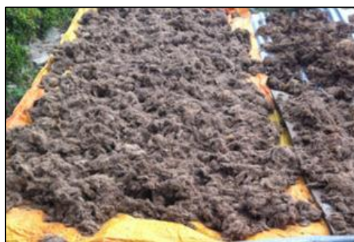
Gambar 3. Penjemuran TKKS setelah proses pencacahan dengan mesin pabrik.
